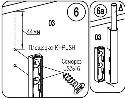
Установите толкатель K-PUSH, для этого примерно по центру горизонтальной стенки (03) наколите шилом отверстие на расстоянии 44мм от лицевого края, приложите площадку K-PUSH и зафиксируйте двумя саморезами US3x16. Наденьте толкатель на площадку K-PUSH. Теперь, чтобы открыть дверь, нажмите на дверь в том месте, где установлен механизм K-PUSH. Регулировка срабатывания производится вращением штока А после установки двери.
